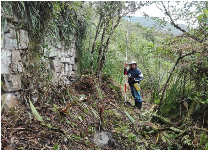
Figura 3. Proceso de levantamiento geodésico con el método RTK.
