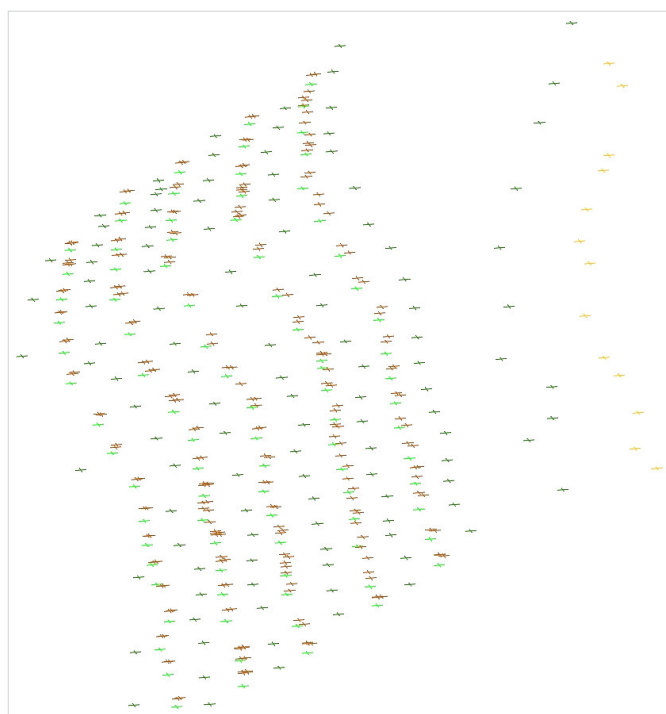
Figura 5. Nube de puntos y modelo topográfico digital del sector «La Arena 2» a partir de los datos de campo.
