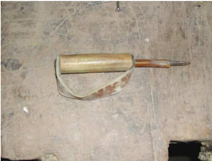
Figura 2. Artefacto denominado por los agricultores como «timpina», el cual es para deschalar el maíz.
