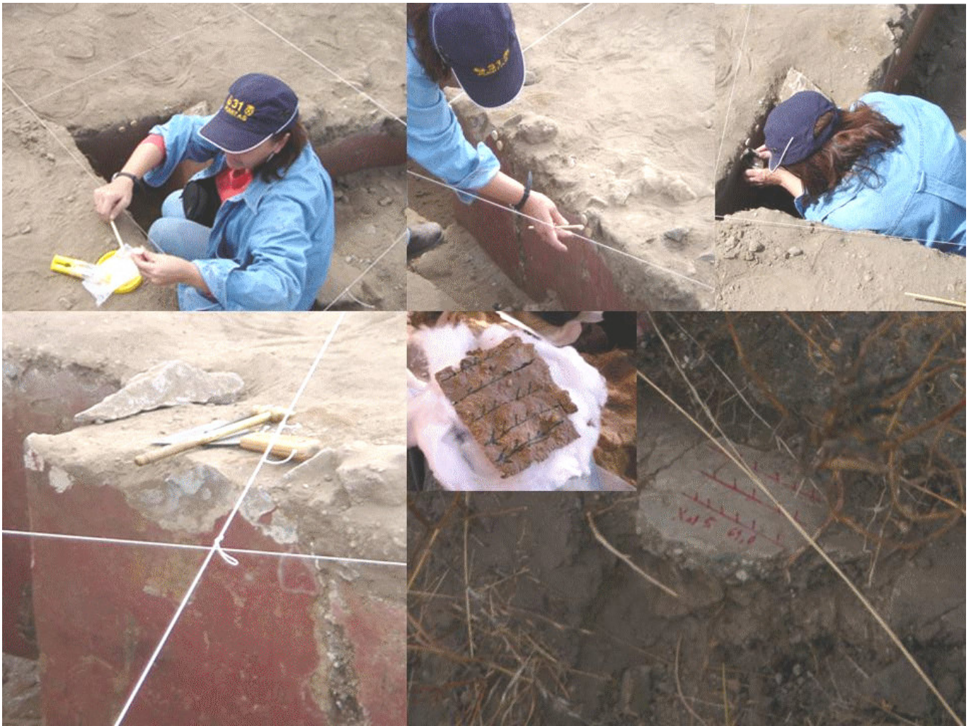
Figura 2. Toma de muestras en Xalasco, Tlaxcala. Adhesión de testigos de madera con pegamento epóxico. Orientación con brújula magnética Brunton. Obtención de testigos con herramientas no magnéticas. Muestras de bloque orientadas con brújula Brunton.
