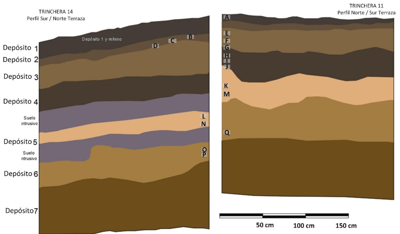
Figura 2. Perfiles estratigráficos superpuestos y fechas radiocarbónicas en las trincheras 14 (terrace N) y 11 (terrace S). Edades calibradas: A) 225-139 AP, B) 475-312 AP, C) 512-428 AP, D) 645-585 AP, E) 889-793 AP, F) 1286-1175, G) 1352-1287 AP, H) 1416-1339 AP, I) 1425-1352 AP, J) 1523-1337 AP, K) 1950-1822 AP, L) 2126-1987 AP, M) 2600-2493 AP, N) 3185-3000 AP, O) 3493-3381 AP, P) 3879-3968 AP, Q) 4092-3956 AP.
