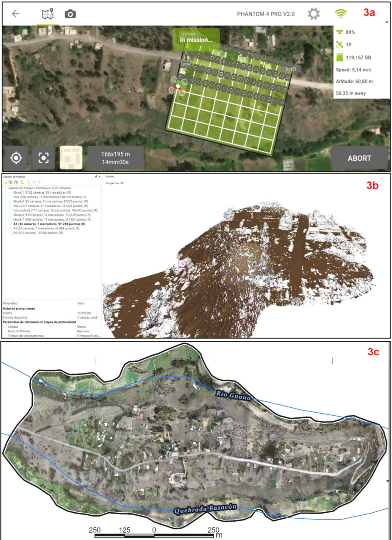
Figura 3. Fotogrametría mediante RPAS de la meseta de Lluishi. 3a) Planificación y ejecución de los vuelos fotogramétricos. 3b) Procesamiento de datos con Agisoft Metashape . 3c) Generación de productos cartográficos con ArcGIS Pro .
